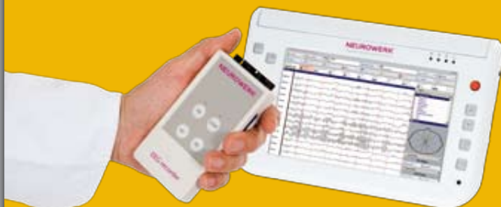
Ausführung: NEUROWERK EEG mobile bestehend aus dem EEG recorder mit einem Tablet PC als EEG-Monitor ↑
